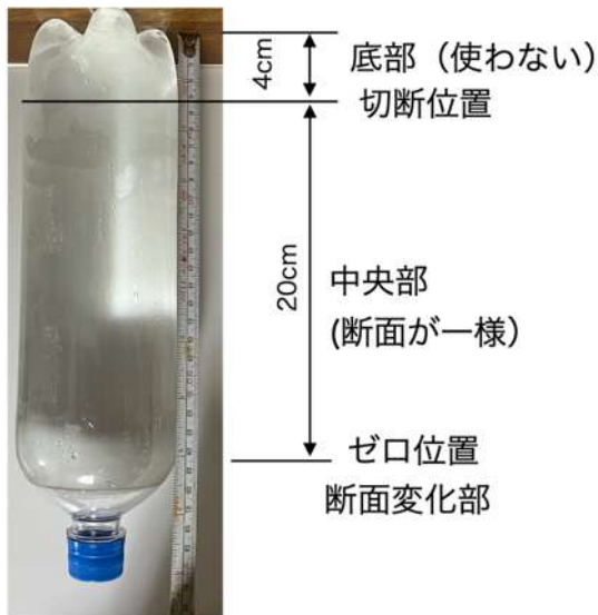
図2：上下逆さまに用いたペットボトル雨量計 (数値はペットボトルにより異なる)
