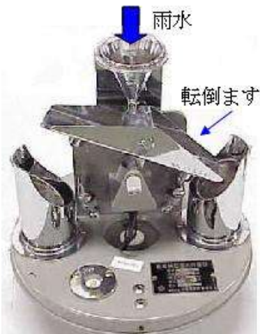
気象庁：転倒ます型雨量計の内部
