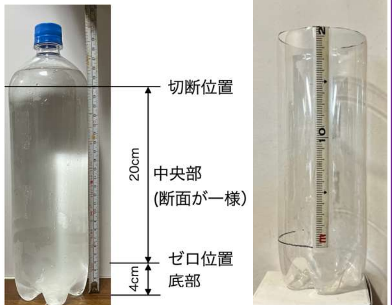
図1：雨量計に用いたペットボトルと完成品 （数値はペットボトルにより異なる）
